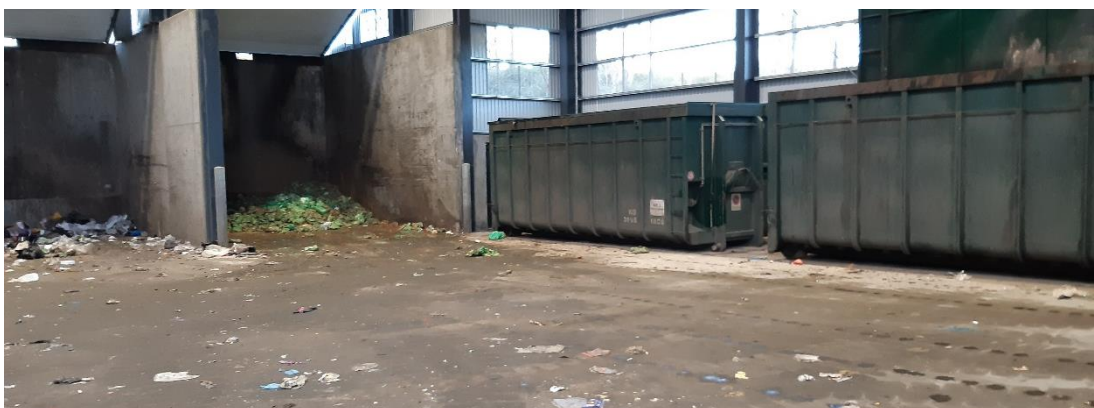
Figur 3. Omlastestation til dagrenovationslignende materiale. Øverst: Sorteringshallen udefra. Midterst: Hul i gummilisten på porten til hallen. Nederst: Sorteringshallen. De grønne poser indeholder madaffald køres til biogasanlæg, mens det resterende affald køres til forbrænding.
