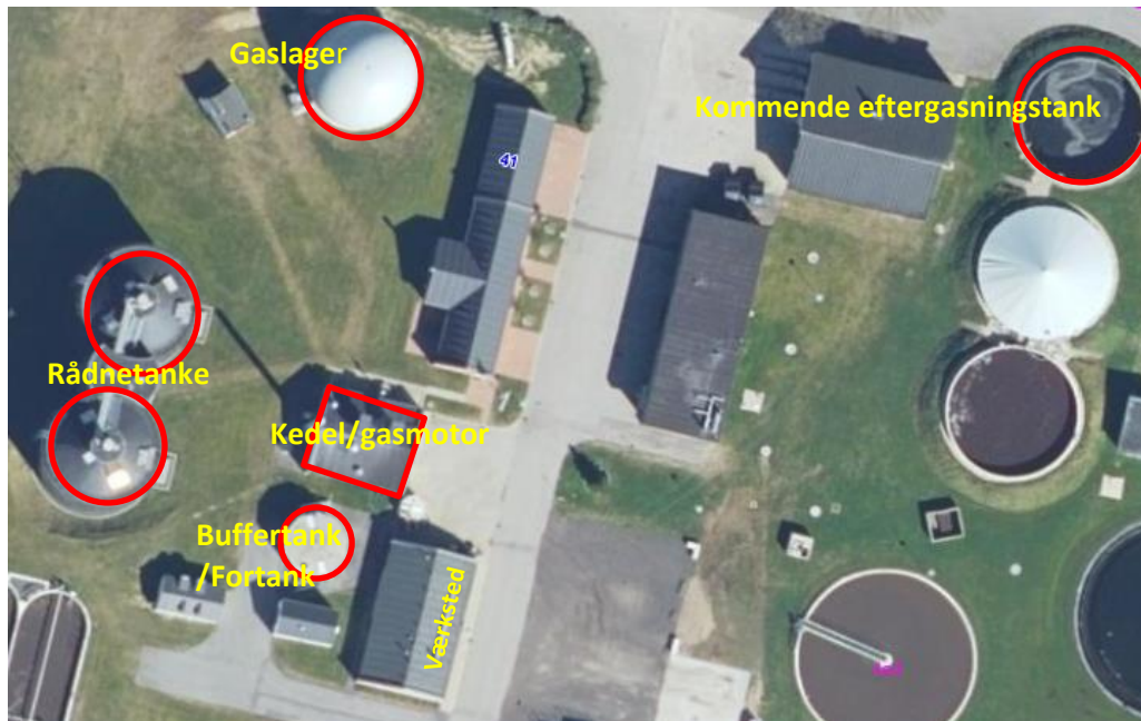
Fig. 4 Situationsplan for eksisterende biogasanlæg
