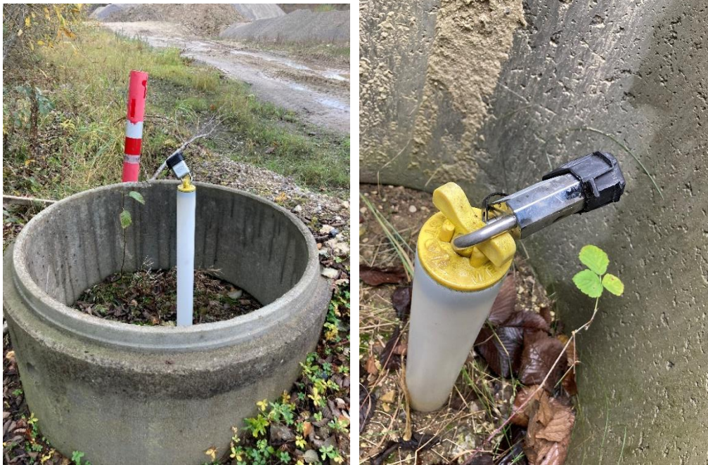
De 5 nye borerer er alle forsynet med tæt prop og hængelås, der ved tilsynet var aflåst.
