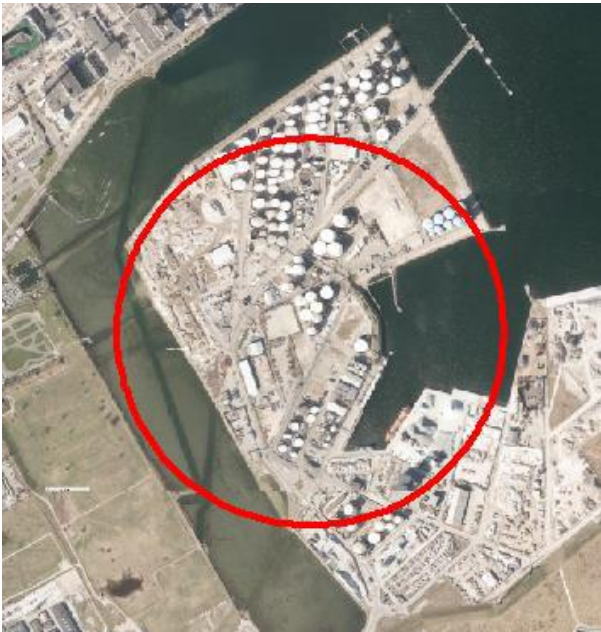
Figur 6 Eksplosion i gassky, konsekvenszone for et eksplosionsovertryk på 5 kPa (50 mbar) (Samtanks sikkerhedsrapport 2023, bilag 30).
