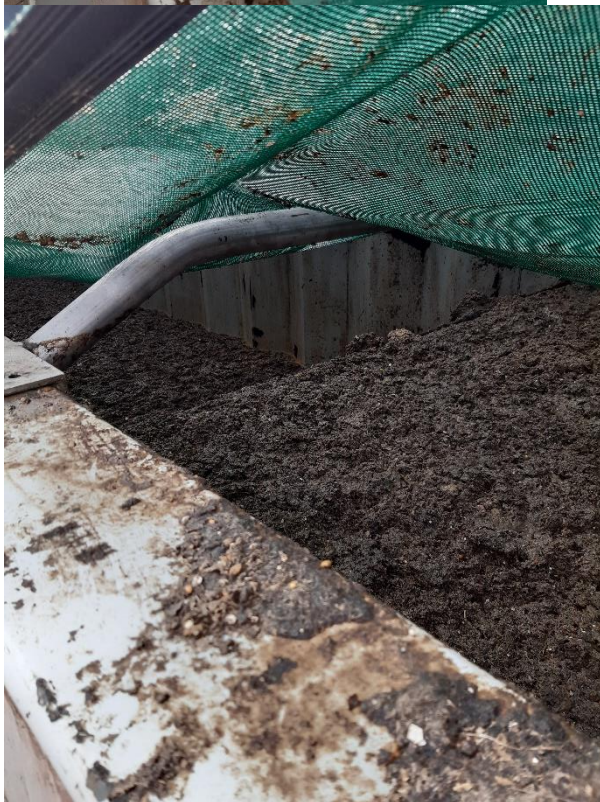
Figur 12 Container til den færdige pulp, hvor det først skal passere et sandfang for at gå videre til den anden del af containeren, hvorfra pulpen kan pumpes over i en tankvogn, som kører det til renseanlægget.
