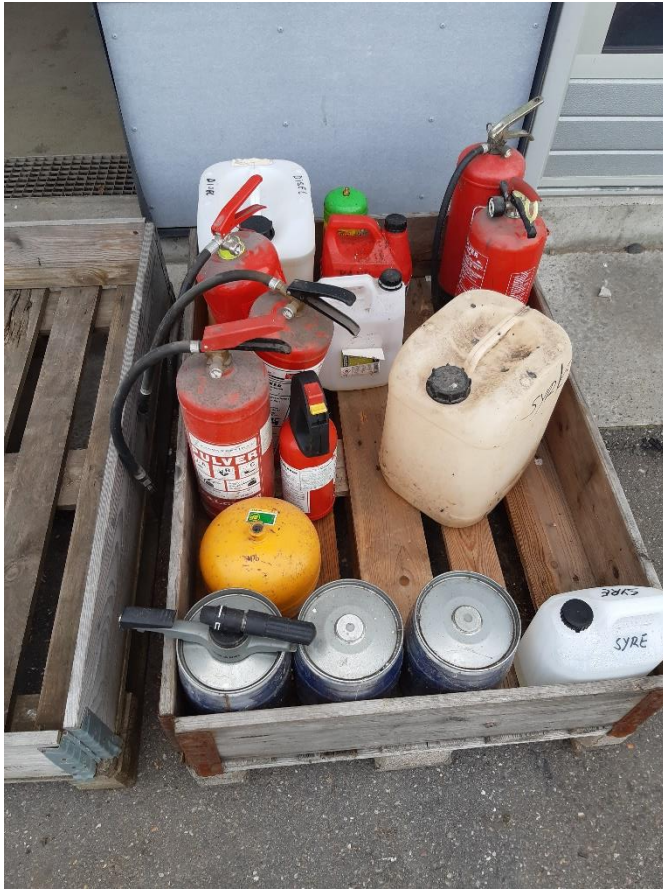
Figur 7 Palle med farligt affald i form af noget syre og anden væske står udenfor på asfaltbelægning uden overdække eller spildbakke.
