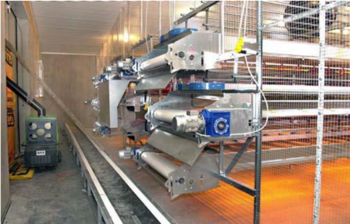
Figur 1. Billedet til venstre viser gødningsbåndene, som afleverer den faste gødning ved enden af systemet i en tværkanal/transportbånd, der transporterer den faste gødning ud af stalden. Øverste billede viser et anlægget med høns. Billedet fra billed databasen, Videncentret for Landbrug, Fjerkræ.
