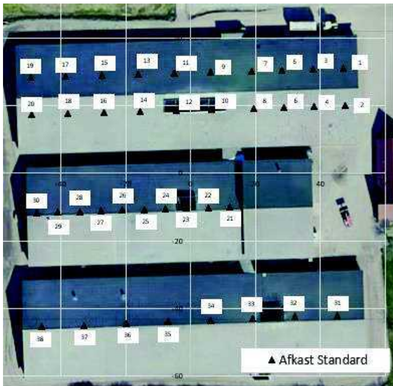
Figur 3: Skitse over placeringen af afkast i standard drift
