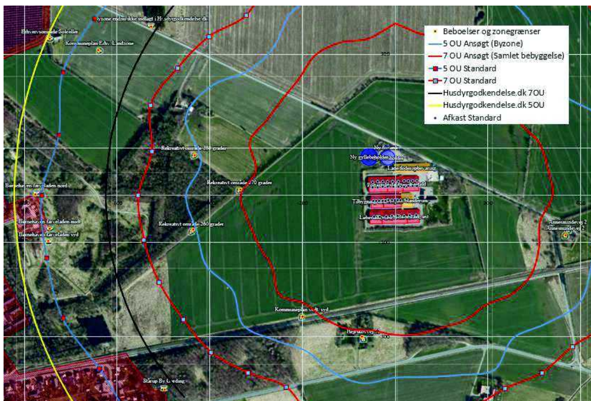
Figur 4. Grafisk visualisering af isokurver for lugtgenen ved hhv. ansøgt produktion med ventilationstekniske tiltag i form af samlet afkast, dels en ventilationsteknisk standardløsning, dels standardmodellens genegrænse i Husdyrgodkendelse.dk
