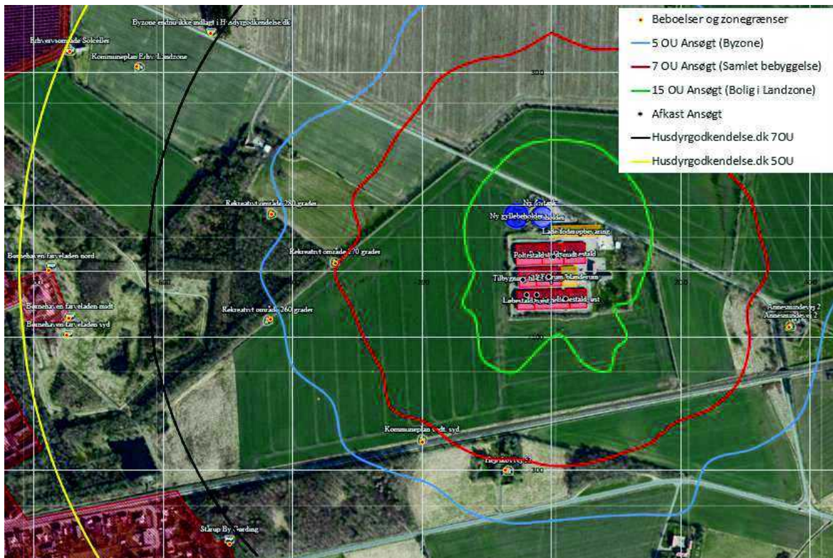
Figur 1. Grafisk visualisering af isokurver for lugtgene fra produktionen Annesmindevej 1
