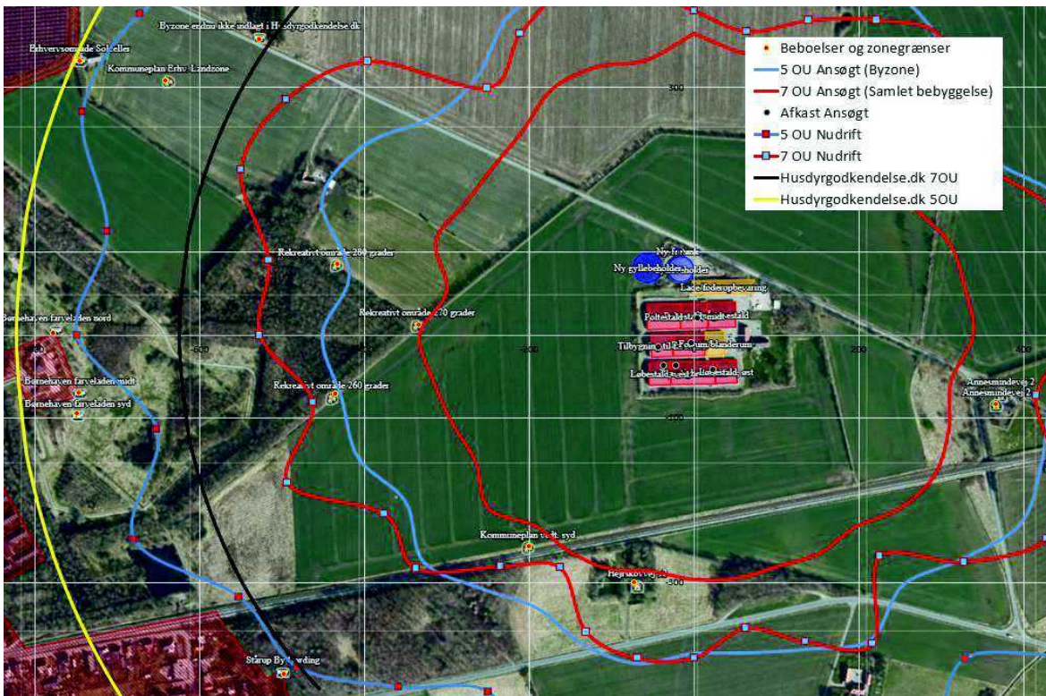
Figur 8. Grafisk visualisering af isokurver for lugtgene fra produktionen med ansøgt ventilationsdesign og lugtspredningen i nudrift.
