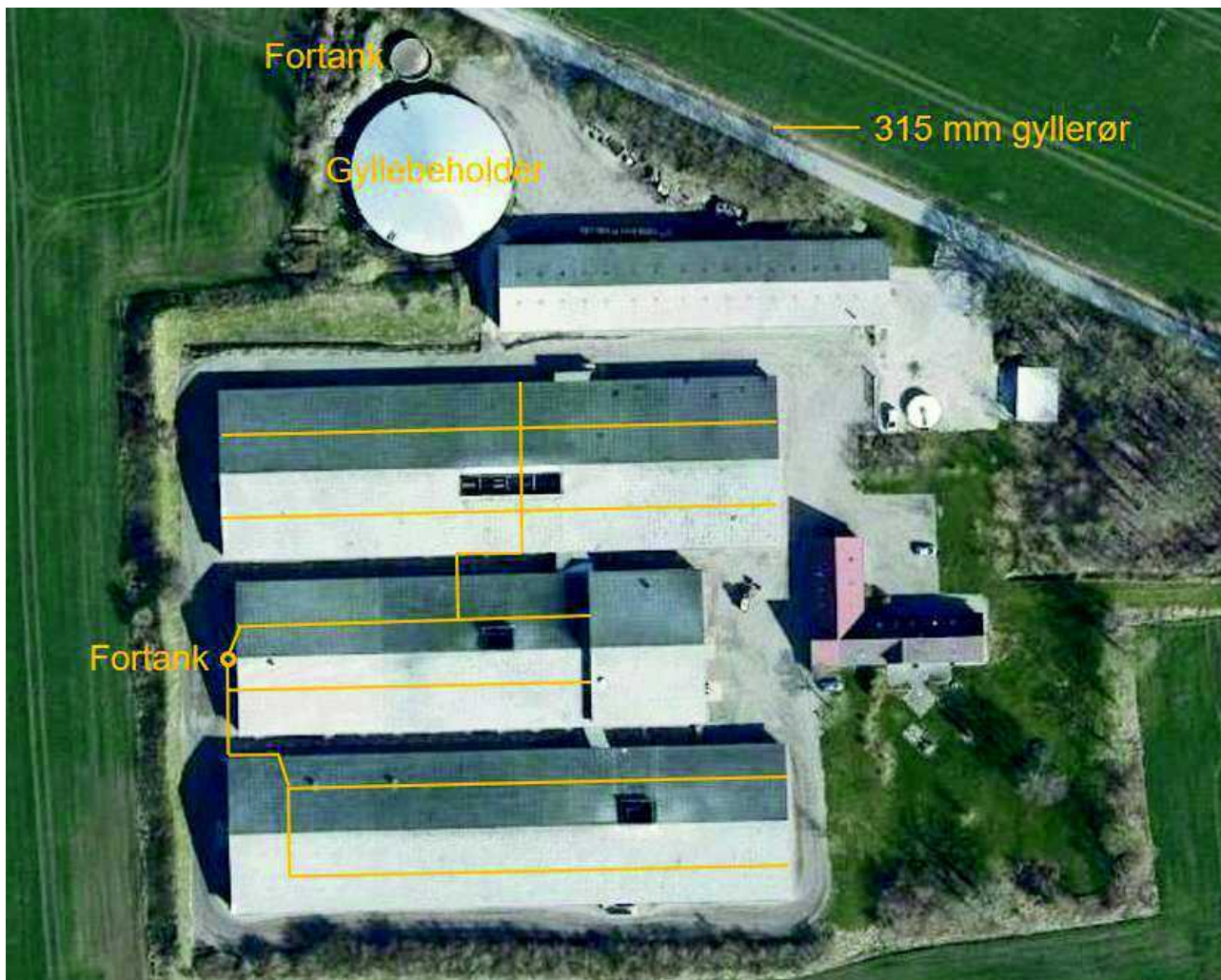
Figur 2. Oversigt over rørføringen af gylle i staldene
