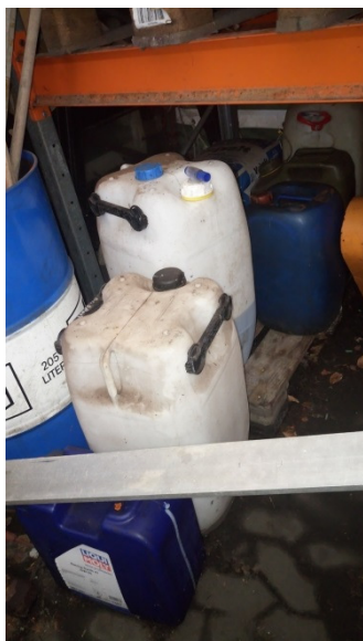
Fig. 1: opbevaring af kølervæske/sprinklervæske i telthallen. Gulvet er af sf sten og derfor ikke tæt.
