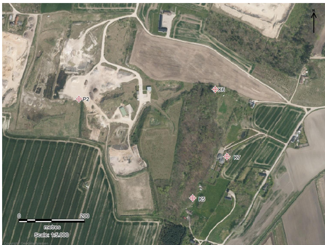
Figur 1. Skovsted losseplads med placering af monitoringsboringer. P2 er opstrøms, mens de øvrige er nedstrøms deponiet. Kilde: deponiets årsrapport
