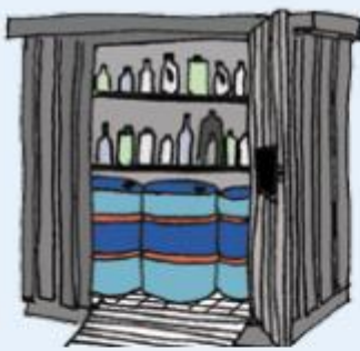
Figur 2: Udendørs opbevaring i container med dobbelt bund.
