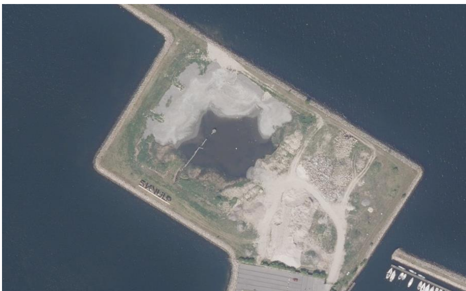
Figur 5. Orthofoto, sommer 2018. Gråt område indikerer at sediment er tilført korrekt til deponiet.
