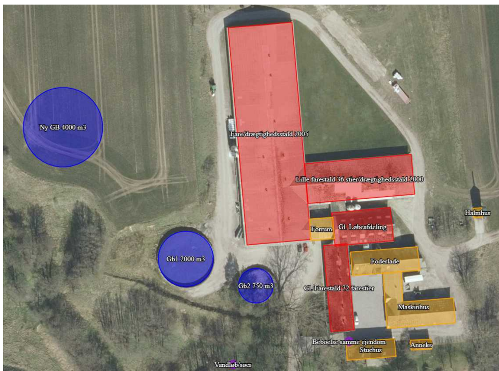
Figur 1: Placering af staldafsnit og opbevaringsanlæg m.v. ("Ny GB 4000 m 3 " opføres med kapacitet på 5000 m 3 , men samme overfladeareal)
