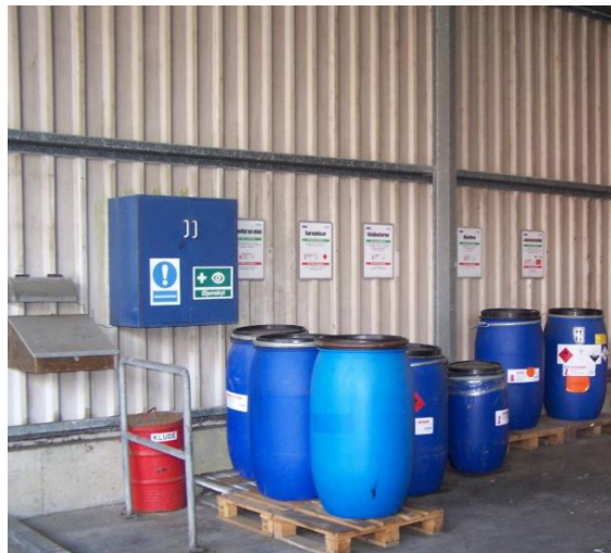
200 l plasttromler eller spændelågsfade med olie – og kemikalieaffald etc. Fin skiltning.
