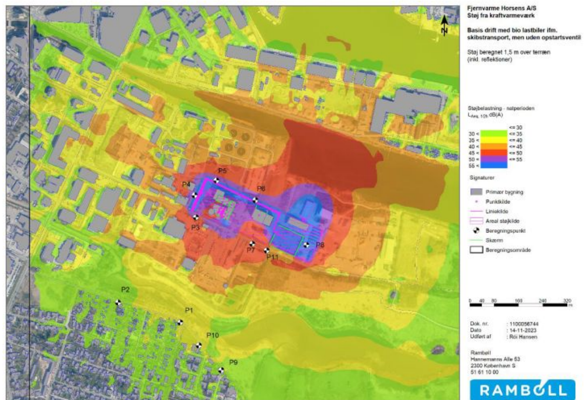
Figur 16-2 Scenarie med bio lastbiler fra skib men uden opstartsventil. Støjdbredelse beregnet i 1,5 meter højde over terræn.
