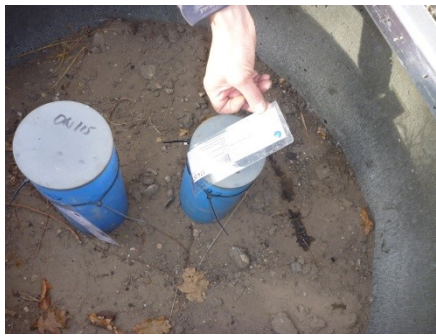
Figur 7 Monitoringsbrønd AV5 (TV) og AV6 (TH). Alle deponiets boringer fremstod i god stand og med aflåst betonring, prop i forerør og label med både DGU og lokal nr.
