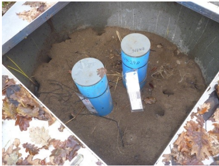
Figur 7 Monitoringsbrønd AV5 (TV) og AV6 (TH). Alle deponiets boringer fremstod i god stand og med aflåst betonring, prop i forerør og label med både DGU og lokal nr.
