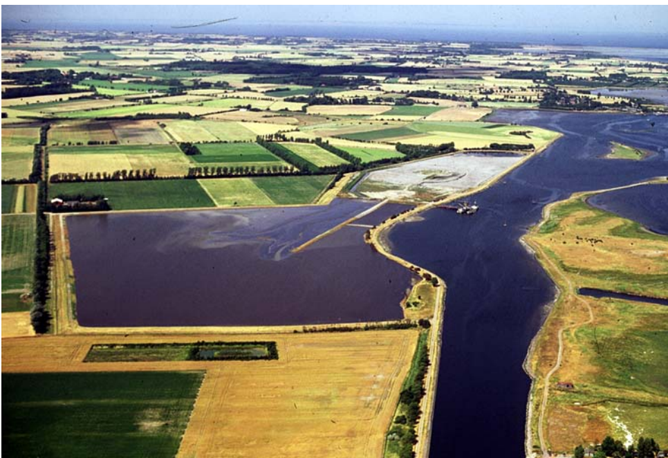
Foto fra 8. juli 1992 efter indspuling til Sektion I. Overskydende vand ledes til nye spulefelt, der på dette tidspunkt er helt vanddækket (25 ha).
