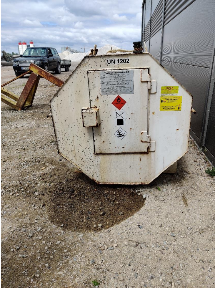
Entreprenørtank med tydelig tegn på oliespild foran.
