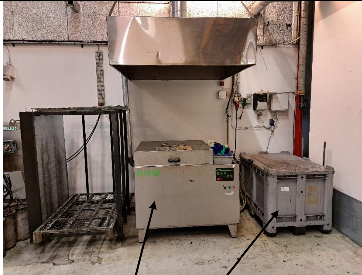
Billede nr. 13: Boltvaskemaskine og beholder til rensesvæske til opløsning af maling (2024)
