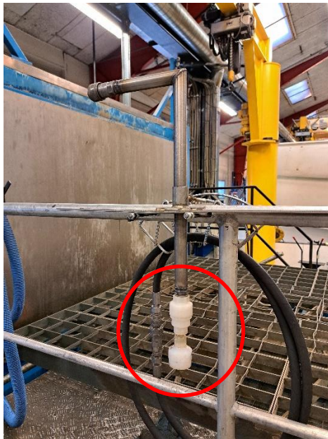
Billede nr. 5: Ny anordning med dysehoved, der benyttes ifm. rengøring af gearhuse (2024)
