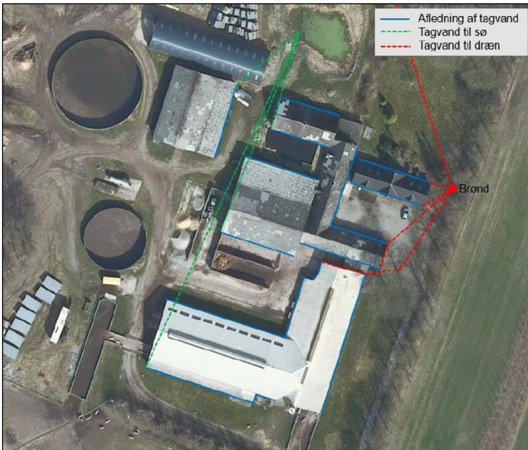
Figur 4. Oversigt over afløbning af tagvand.
