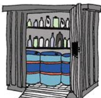
Figur 2 Udendørs opbevaring i container med dobbelt bund.
