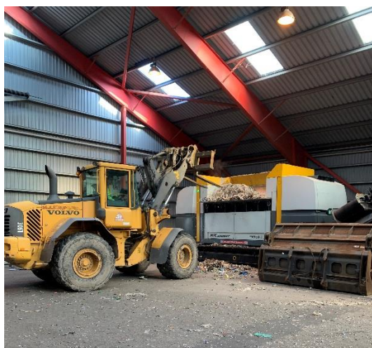
Neddeler for restaffald og plastaffald samt fødnig af affaldet med gummihjuls læsser (th)
