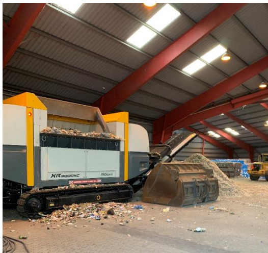
Neddeler for restaffald og plastaffald samt fødnig af affaldet med gummihjuls læsser (th)
