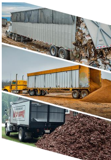
Walking floor trailer (tv) og tiptrailer (th)
