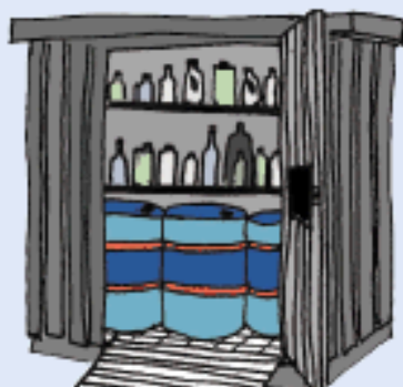
Figur 2: Udendørs opbevaring i container med dobbelt bund.
