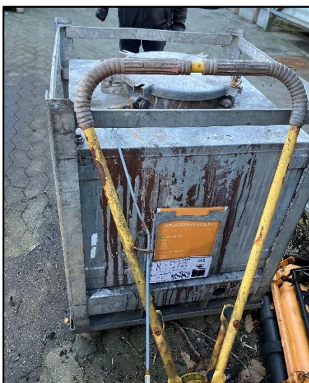
Benzin- og dieselblanding i enkeltvægget beholder på SF-sten. Spild på belægning
