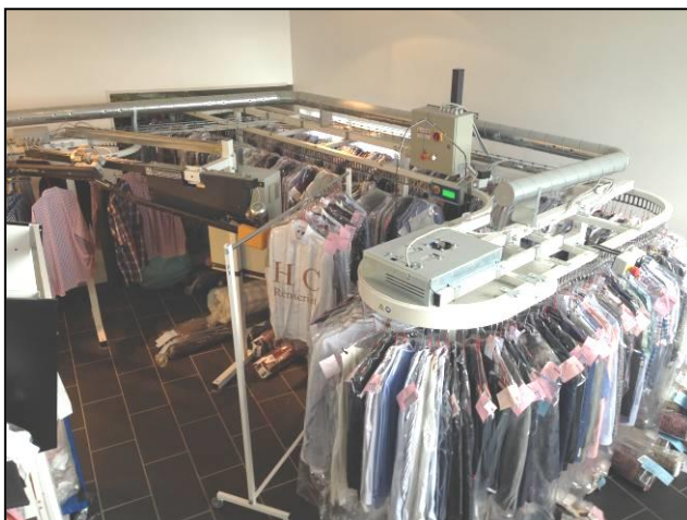
Pakkemaskinen, som automatisk registrerer tøj til afhentning. Maskinens størrelse har bevirket en lille karnap på bagsiden af bygningen.
