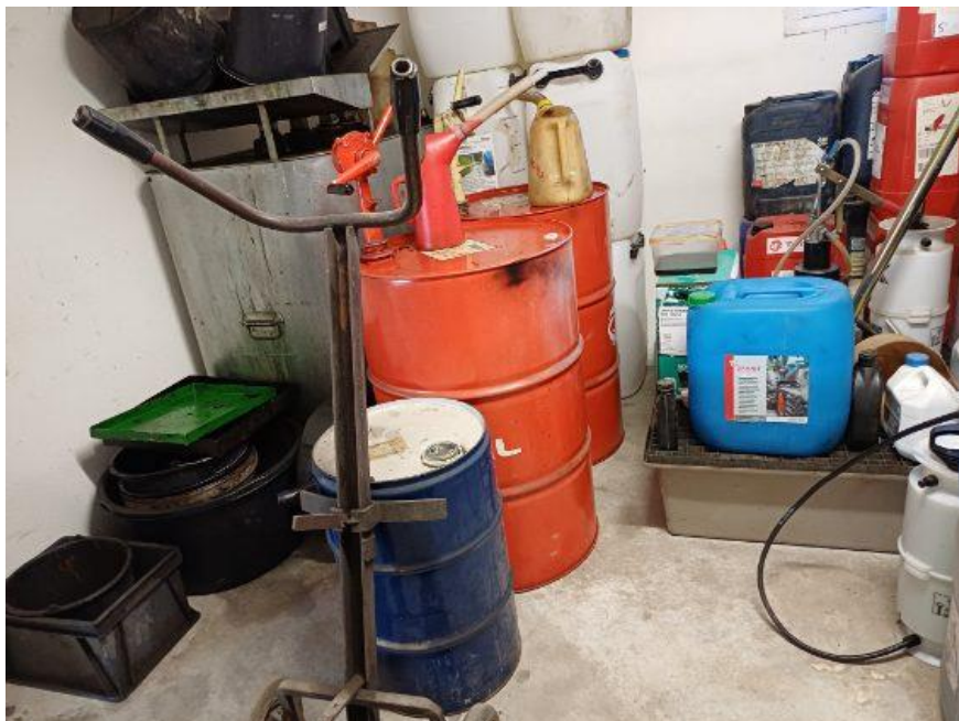
Dobbelt skroget tank til brugt olie samt afdrypnin gaf filtre, samt div. oplag på spilbakke /tæt belægning.
