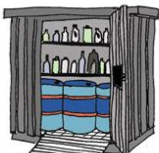
Figur 2 Udendørs opbevaring i container med dobbelt bund.
