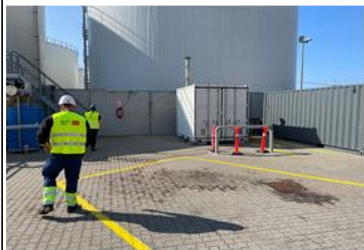
Plads til import fra lastbiler. Misfarvningen af fliserne skyldes et uheld ved import, hvor chaufføren ikke var fortrolig med udstyret på egen lastbil. Hændelsen burde have affødt en afvigelse.
