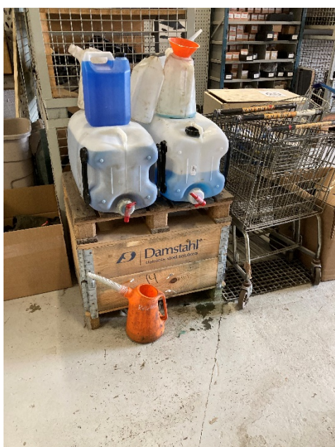
Foto 1: Kølervæske i dunke med tapphane. Der er afløb ved siden af dunkene.
