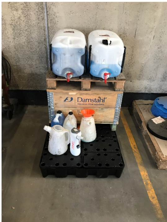
Foto 2: Kølervæske og kemikalier på spildbakke (Foto taget af Henrik Hatting, Almas, efter tilsynet)
