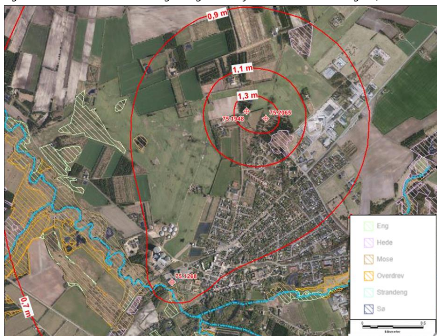
Figur 4.28: Grundvandssænkning beregnet i miljøkonsekvensvurderingen fra 2018 ved en indvinding på 197.950 m 3 /år (S0).
