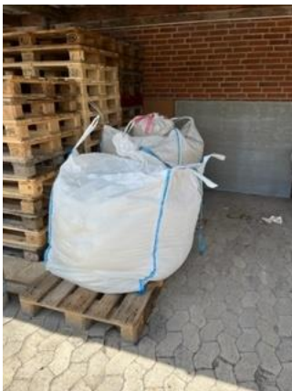
Figur 2: Støv fra glasfiberskærer opsamles i bigbag poser, Odin sender information/dokumentation for hvor det afleveres.
