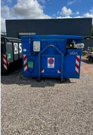
lukket container med aftapning, til olieholdige metalspåner.
