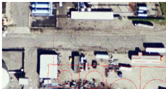
Figur 9.4.3 Placering af rørføring mellem tankanlæg og raffinaderi.
