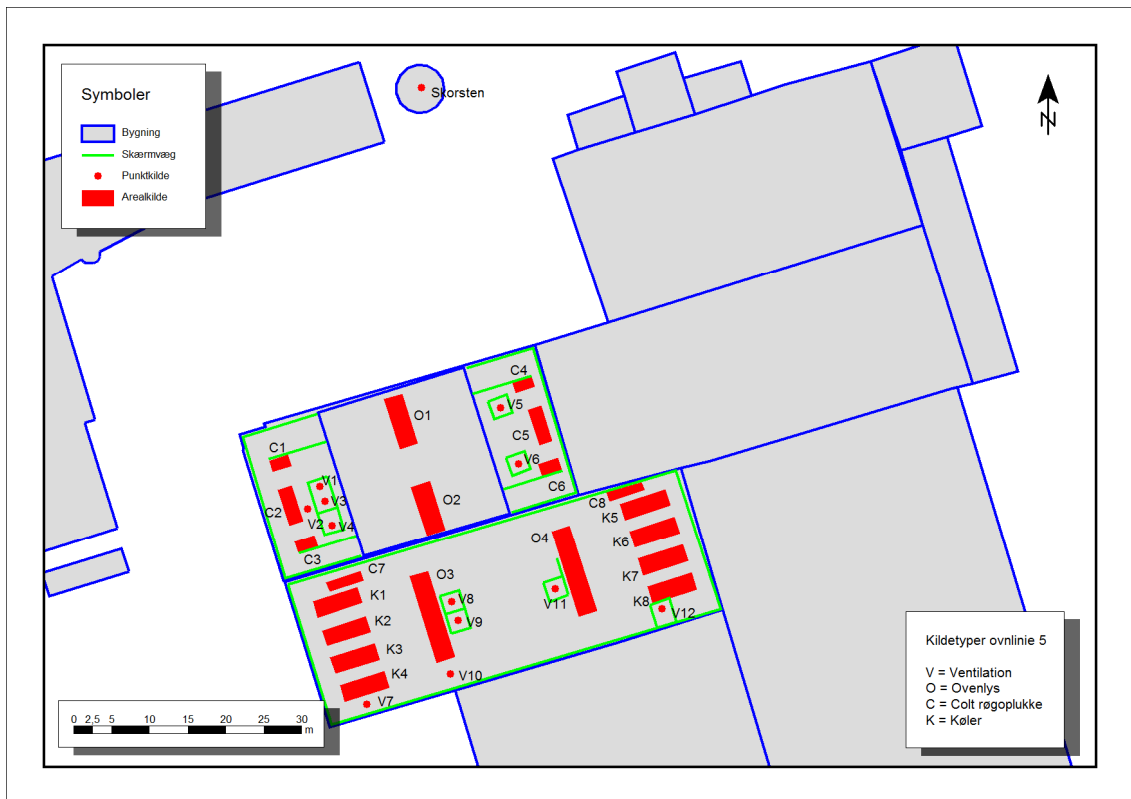
Figur 4: Støjkilder på tag af ovnlinie 5 med alle støjskærme
