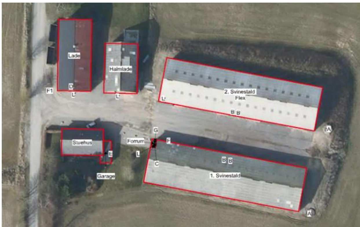
Figur 1: Situationsplan med placering stalde og opbevaringslagre. Se også Bilag 1: Situationsplan 3 . A – Opsamling vaskevand. B – Fodersilo. C – Medicin. D – Kunstgødning. E – Olie-tank. F – Døde dyr, opbevaring. F1 – Døde dyr afhentningsplads. G – Rengøringsmidler. L – Lys.
