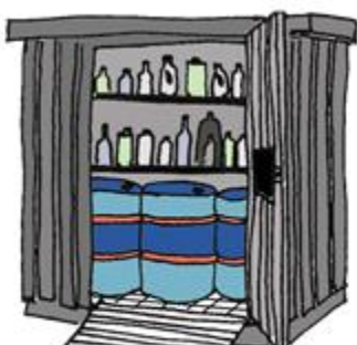
Figur 2 Udendørs opbevaring i container med dobbelt bund.
