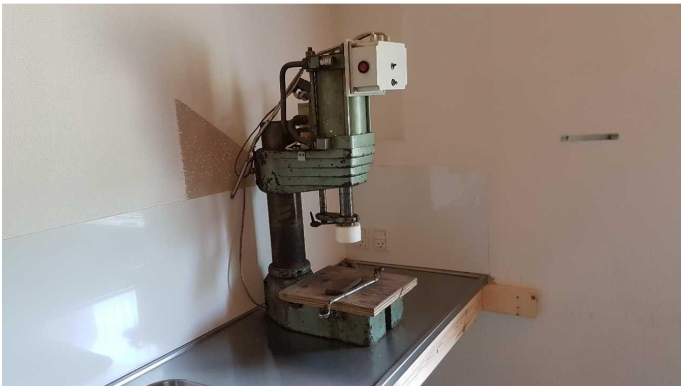
Presse til formgivning af specialemer i plast.
