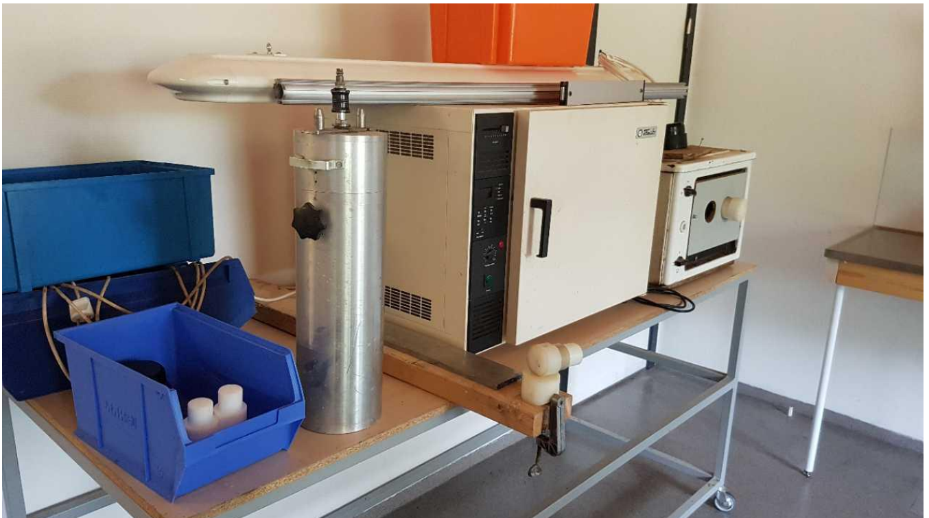
Ovn til blødgøring af plast, der skal formgives ved produktion af specialeemner.
