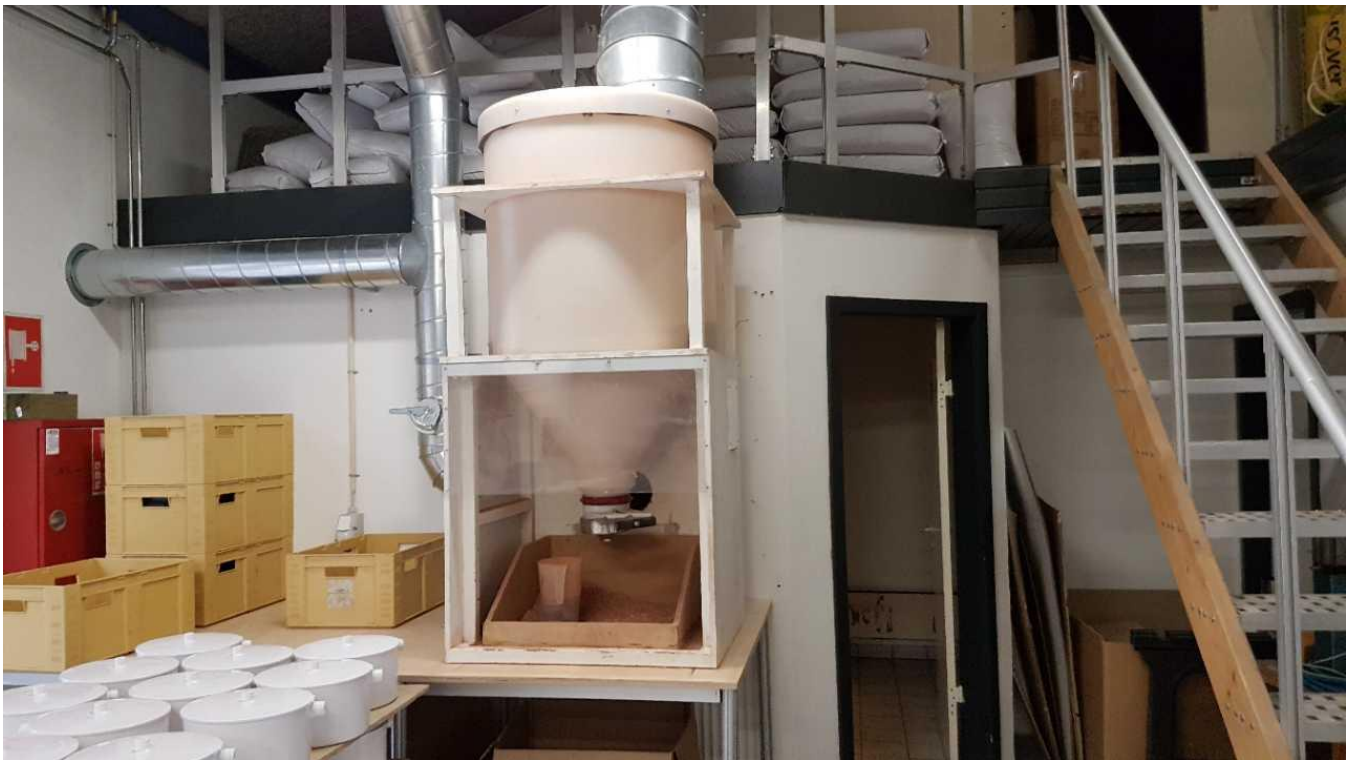
Arbejdsplads i stinkskab til håndtering af kattegrus til amalgamfiltere. Udsuget luft renses i filter.
