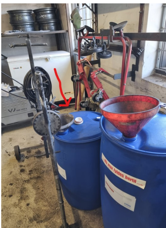
Afløb ved siden af tønder med flydende affald
