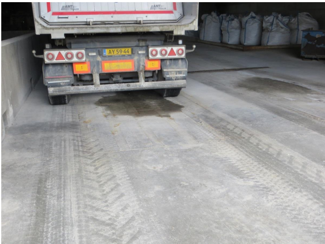
Belægningen i slaggehal er beton. Slaggen læsses fra slaggegrube til lastbil, hvorefter det borttransporteres fra virksomheden. Slaggestøv på belægning løber med vand fra rengøring via dræn tilbage til slaggegruben.
