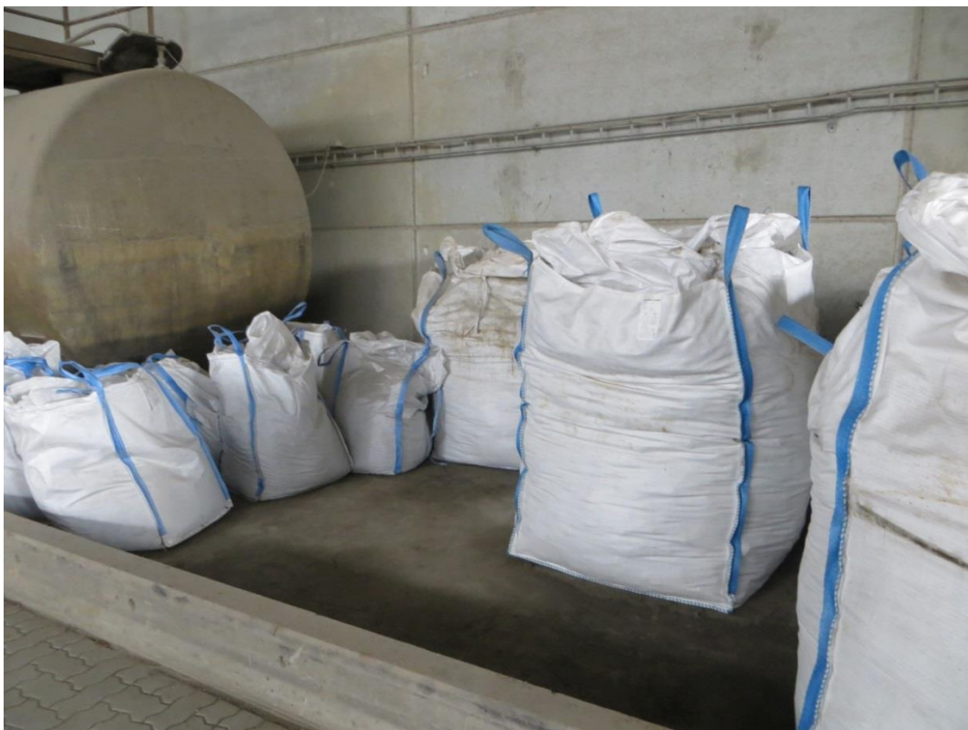
Filterkage i bigbags på betonbelægning med opkant og uden afløb i slaggehal.
