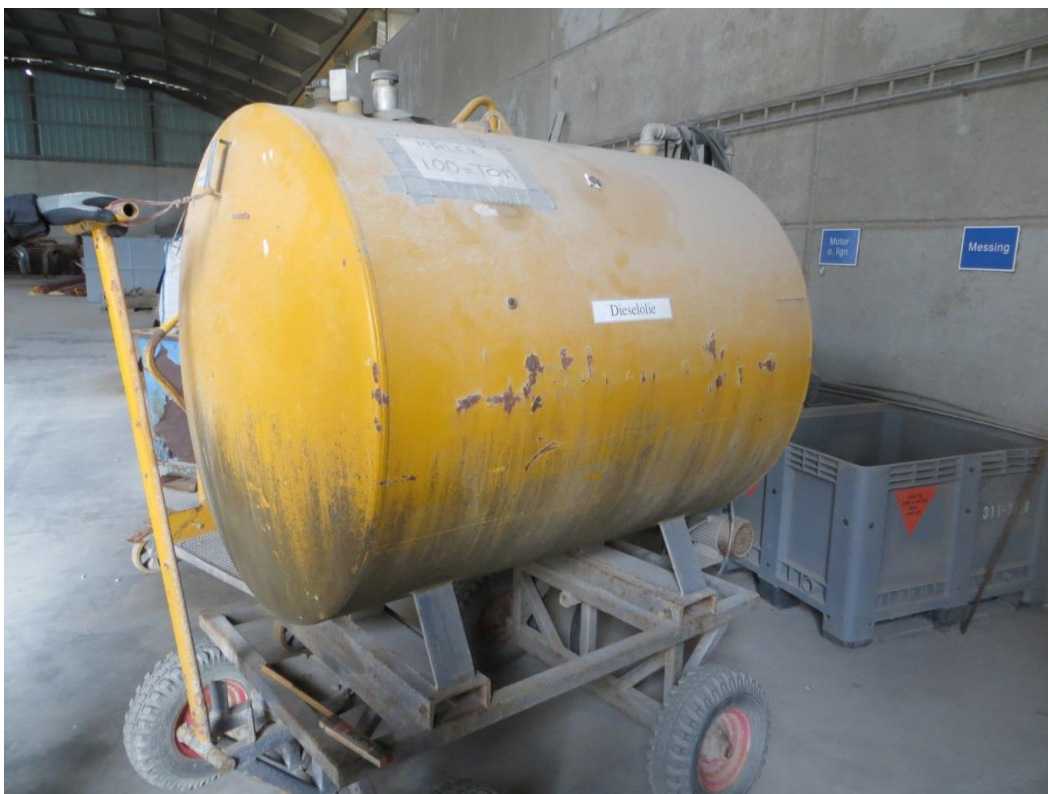
Mobil dieseltank placeret i slaggehal på betonbelægning.
