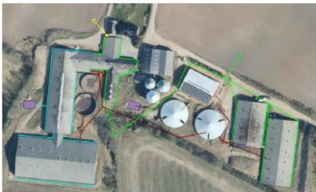
Figur 5 Spildevandsforhold (Lilla markering: faskine, blå+sort streg: afløb til faskine, grøn streg: afløb til drænen, brun streg+markering: gylletank+fortank og gul markering: septiktank)
