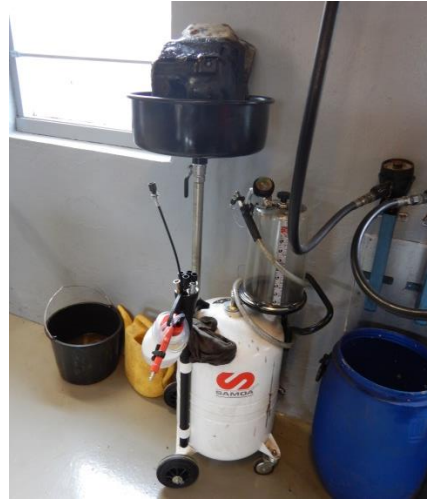
8. Afdrypning og sug fra værksted til spildolietank.
