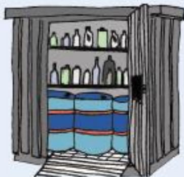
Figur 2: Udendørs opbevaring i container med dobbelt bund.
