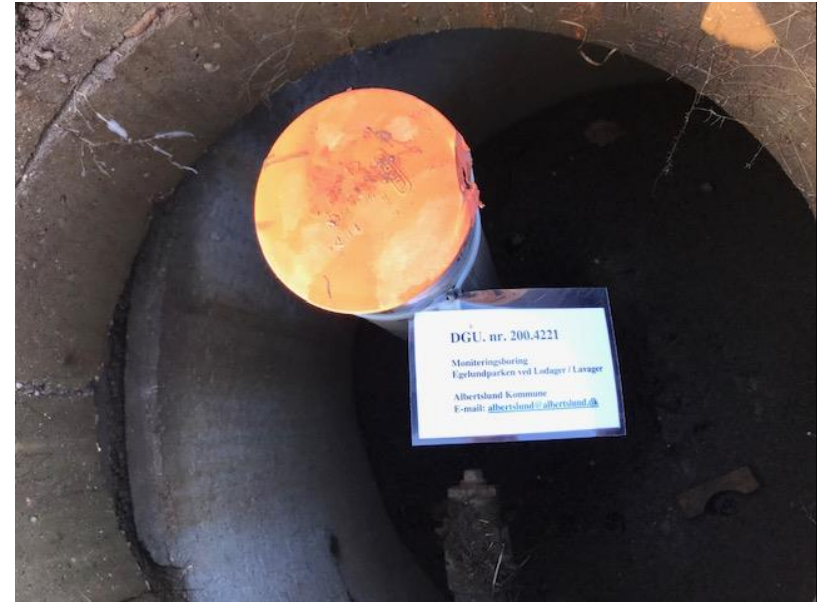
(Højre er taget af Albertslund kommune 27-02-2019, efter de har afmonteret den faste pumpe og sat DGU. Nr. på)
