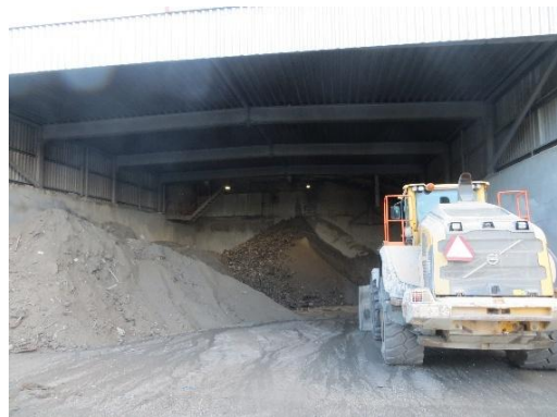
Fælles oplag af forsorteret slagge som læsses på containerbiler og afhentes af ekstern vognmand.
