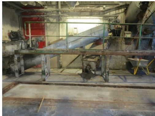
Området til udtag af restprodukter med det gamle udmadningssystem, som Nordværk ønsker at beholde.
