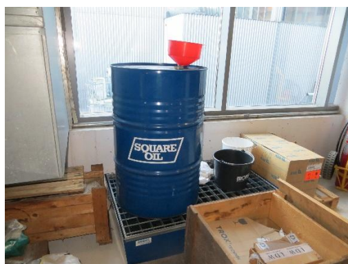
Tønde til spildolie står på spildbakke.
