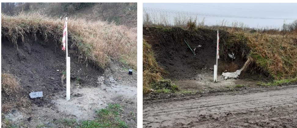
Figur 8. Nye opstrøms monitoringsboringer langs den nordøstvænte vold. Til venstre: Nordlige boring. Til højre: Sydlige boring.
