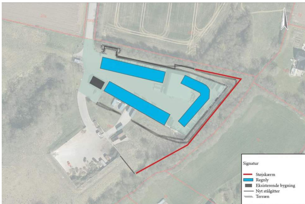
Bilag 6: Placering af støjskærm (NB: Nyt stålgiitter er ikke nyt men det eksisterende stålgiitter)
