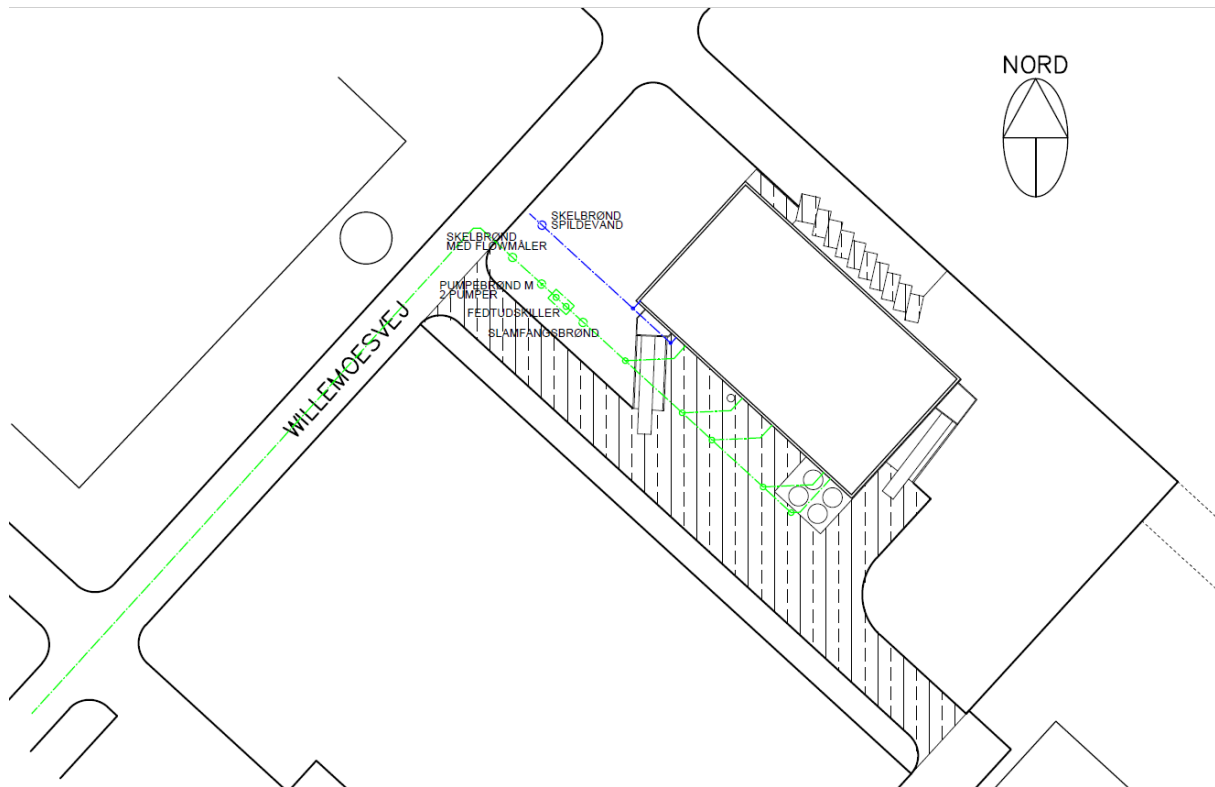
Tegning af virksomhedens spildevandssystem, som kobles på havnens særlige industrispildevandsledning, der føres direkte til flotationskammer på renseanlægget.
