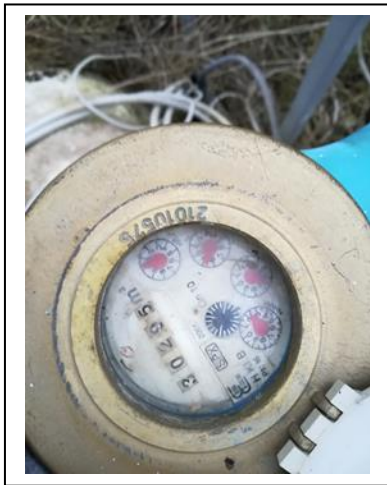
Foto 1: Måler på perkolattank blev aflæst
