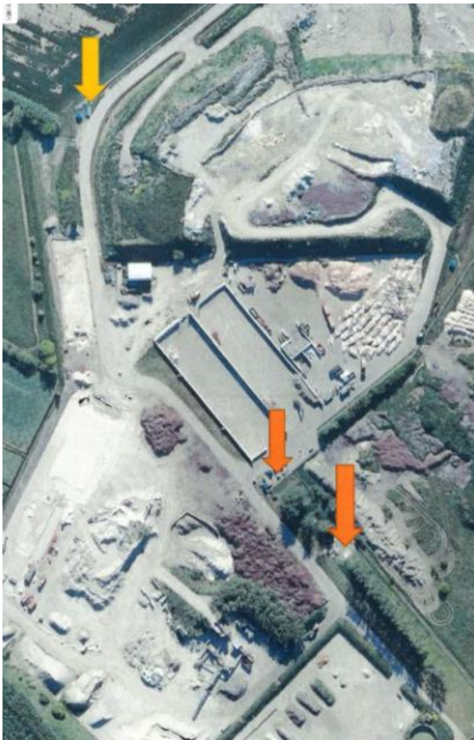
Figur 8-6: Placering af indvindingsboringer (orange pile) og mulighed for at tappe vand til støvbekæmpelse (gul pil)
