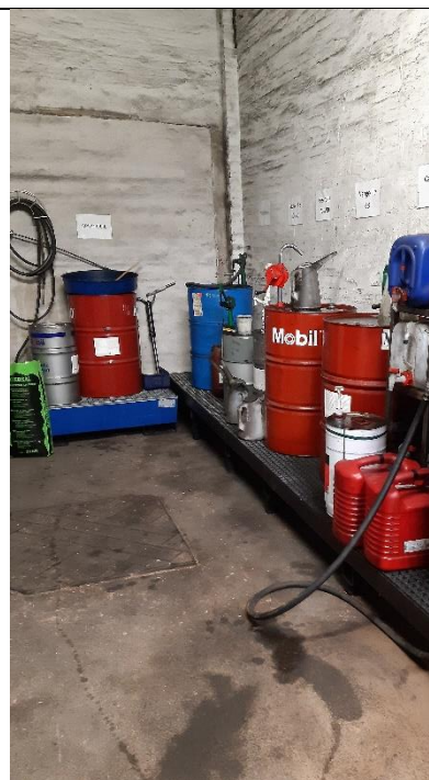
Foto 3: Opbevaring af olie- og kemikalieprodukter på spildbakke. Der er ikke afløb i rummet.
