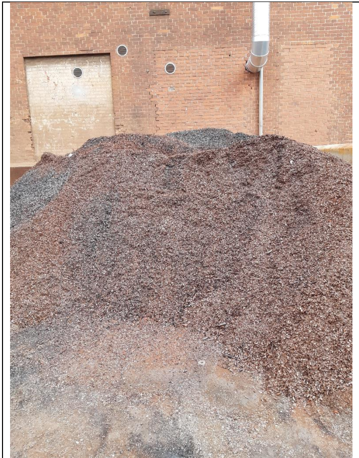
Foto 6: Udendørs oplag af jernspåner, der anvendes til produktion af gråjern og sejjern. Oplag på befæstet areal.
