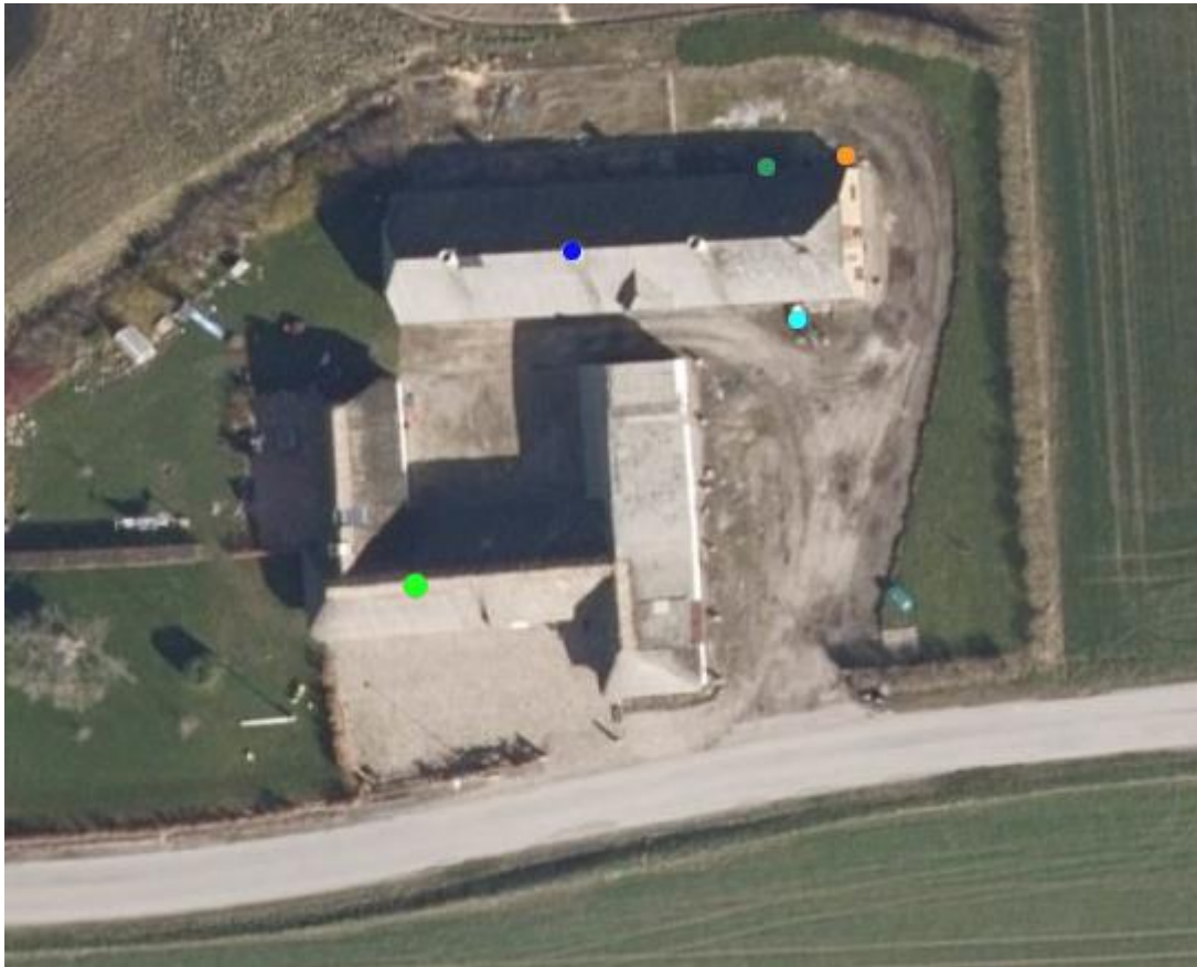
Støjklidernes placering på Højskolevej 23. Ventilationscentrum blå prik. Foderindblæsning mørkegrøn prik. Orange prik gyllepumpning. Turkis prik ind- og udlevering af dyr.
