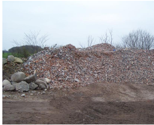
Nedknust byggeaffald ved indkørslen til pladsen
